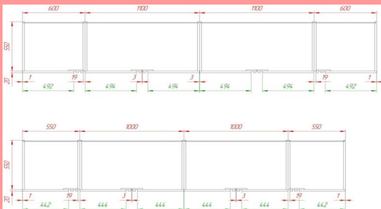
Пример модульного шкафа, вид сверху. Зеленым указана ширина лицевой площади дверей
